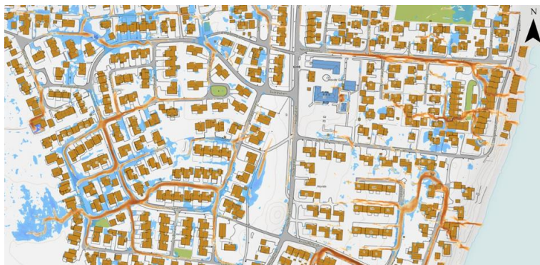
Figur 2-10: Simulering i Brekstad. De blå områdene viser hvor vann samler seg, mens de oransje feltene illustrerer flomveier. Mørkere nyanser av oransje indikerer større vanndybder og høyere vannhastigheter. Bildet er hentet fra Scalgo Live.
