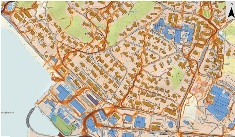
Figur 2-8: Simulering i Bjugn. De blå områdene viser hvor vann samler seg, mens de oransje feltene illustrerer flomveier. Mørkere nyanser av oransje indikerer større vanndybder og høyere vannhastigheter. Bildet er hentet fra Scalgo Live.
