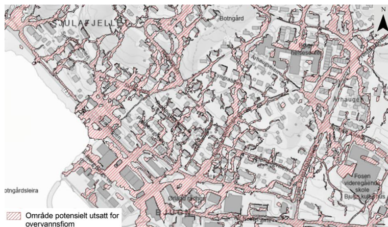
Figur 2-9: Resultater fra simuleringen i Bjugn etter prosessering av dataene. Polygonene viser områder der det kan oppstå store vanndybder og/eller høye vannhastigheter ved ekstreme nedbørhendelser.
