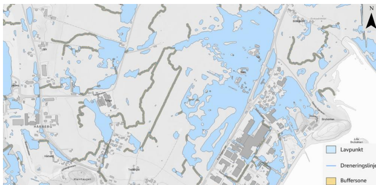
Figur 2-5: Dreneringslinjer med tilhørende buffersoner og lavpunkter i landbruksområder nord for Brekstad. Lavpunktene viser steder der vann sannsynligvis vil samles opp ved kraftig regnhendelser. Dreneringslinjene illustrerer hvordan overvann forventes å renne kun basert på terrengform, og buffersone markerer soner som er potensielt utsatt for overvann.
