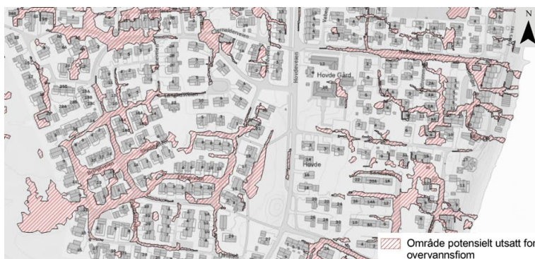
Figur 2-11: Resultater fra simuleringen i Brekstad etter prosessering av dataene. Polygonene viser områder der det kan oppstå store vanndybder og/eller høye vannhastigheter ved ekstreme nedbørhendelser
