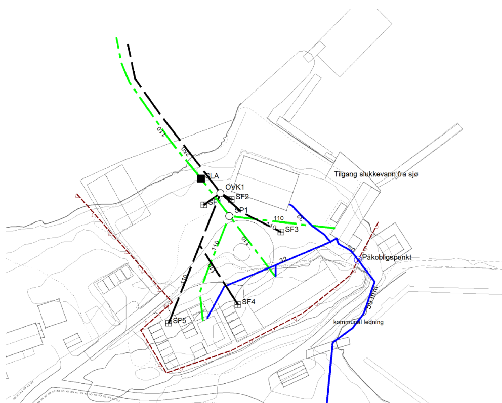
Figur 36 Plantegning som viser ledningstraseer og tilkoblingspunkt
