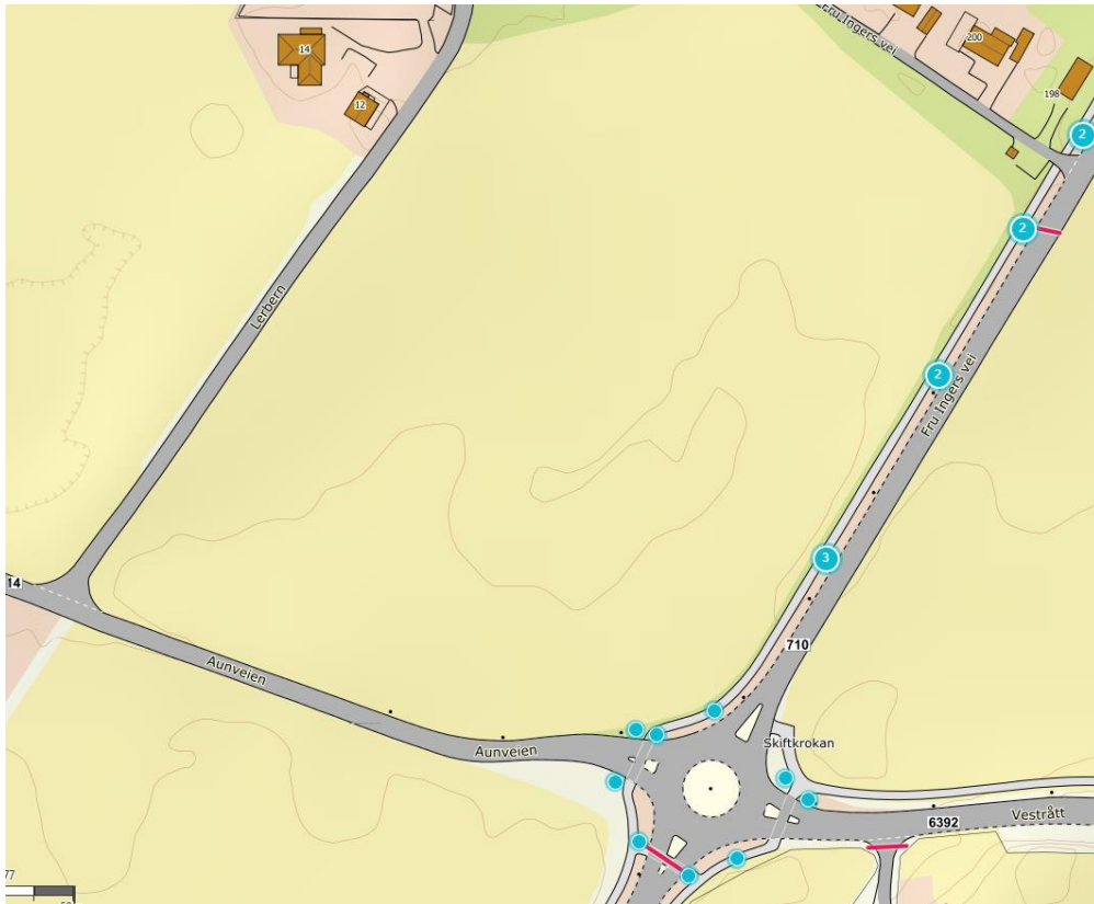
Figur 9: Utsnitt fra vegkart.no med eksisterende sluk/kummer (blå sirkler) og stikkrenner (røde streker).
