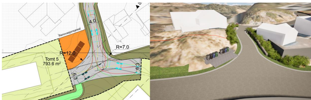
Figur 45: Plassering og manøvrering ved renovasjonsareal f_RA
